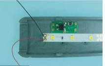
Der Streifen hat auf der Rückseite einen Klebestreifen, die Platine befestige ich mit doppelseitigem Klebeband, aber erst nachdem alle elektrischen Verbindungen hergestellt sind, denn löten auf dem Waggondach wäre nicht so gut. Jetzt haben wir die Position der Platine und können die Litzen von den Drehgestellen in der Länge anpassen.
