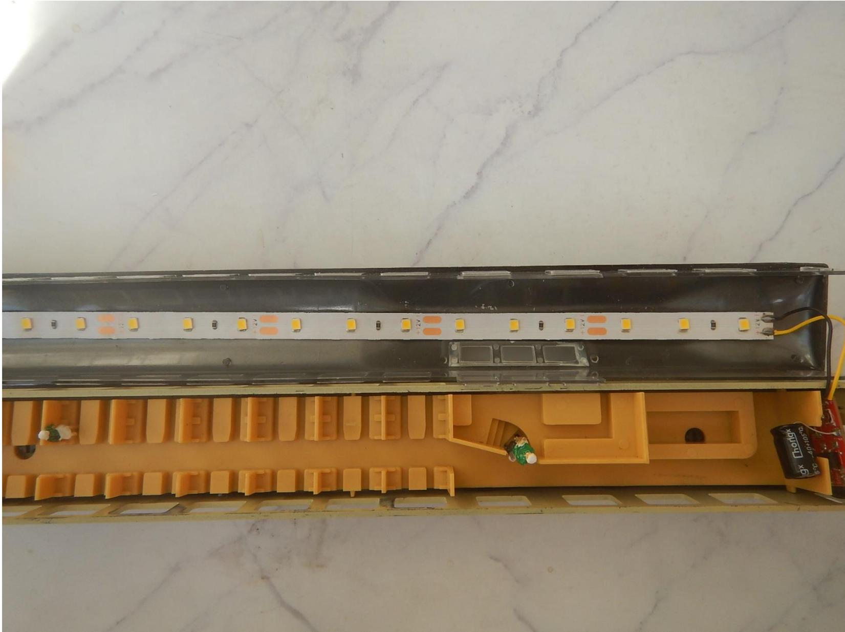
Bei meinem ROCO Waggon, möchte ich den LED Streifen nicht am Dach, sondern auf dem Wagenkasten, befestigen. Dadurch ist es einfacher, das Dach abzunehmen, um z.B. nachträglich Personen einzukleben. Darum muss im Mittelsteg ein Loch für eine LED ausgefräzt werden.
