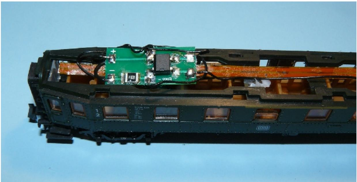
Und hier das Ergebnis. 2 unterschiedlich beleuchtete Waggons mit der gleichen Technik. Unterschiedlich beleuchtete Abteile, Vorne und hinter kaltweißes Licht, ein Abteil nicht beleuchtet (da ist der Elko versteckt) und der Rest auch unterschiedlich in warmweiß.
